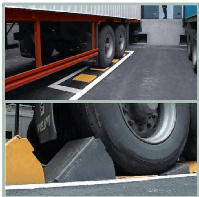
SISTEMA K1 BLOCK PER IL BLOCCAGGIO
